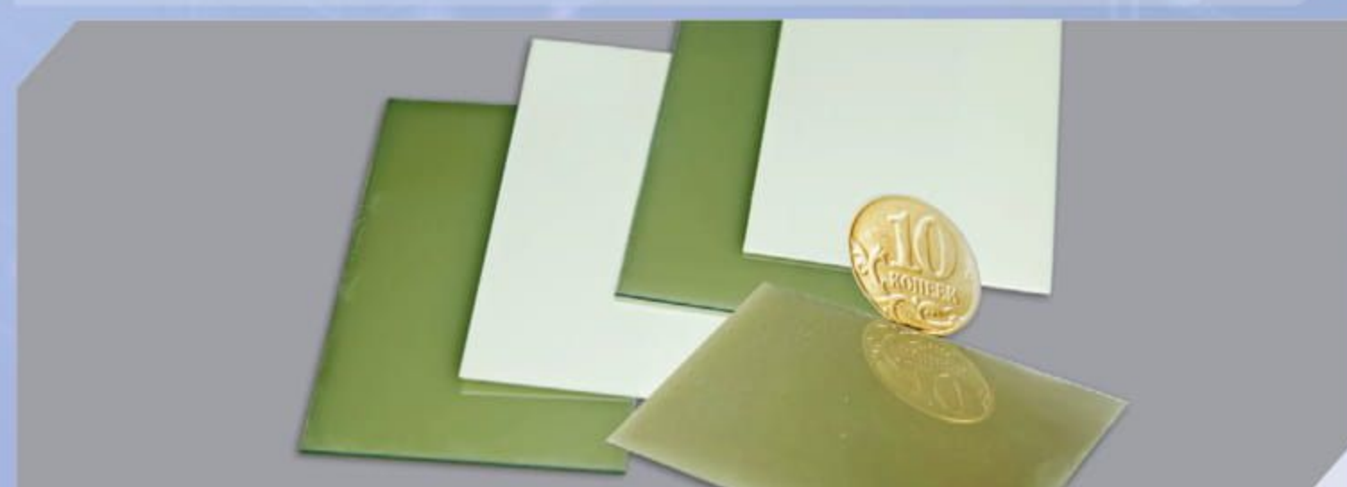
Полированные подложки ВК-100 ( Ra = 0,005 мкм, >14 класс) и AlN ( Ra = 0,03 мкм, 13-й класс).
